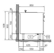
Electrical inlet (power) Equipotential screw
